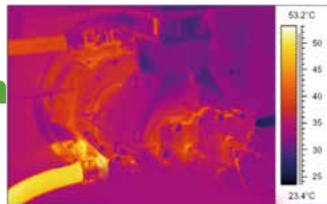
Begrenzter Temperaturanstieg von nur 25 °C im Kompressorelement
