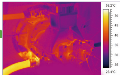
Begrenzter Temperaturanstieg von nur 25 °C im Kompressorelement
