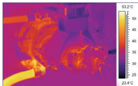
Begrænset temperaturforøgelse på kun 25 °C i kompressorelementet
