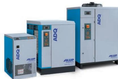
В рефрижераторных осушителях такие негативные последствия устранены благодаря конденсации и отвода находящейся в воздухе воды. Работа осушителя ADQ контролируется с помощью электронного контроллера, представляющего все необходимые данные. Весь модельный ряд рефрижераторных осушителей оборудован системой электронного дренажа конденсата, использующей электронный датчик для отделения конденсата без потерь сжатого воздуха.
