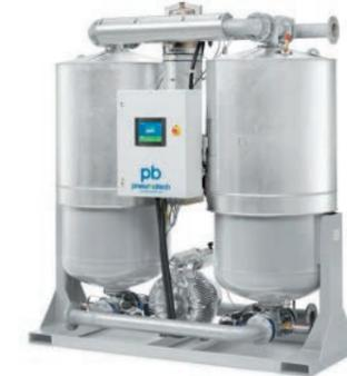
Адсорбционные осушители PB 700–6350 HE ZP осушают воздух до ТРД -40 °С (стандарт) и -70 °С (опция). Адсорбент содержится в сварных колоннах, которые могут работать при давлении 10 бар (усталостная нагрузка). Все стандартные осушители оснащены двумя фильтрами предварительной очистки на входе и одним противопылевым фильтром на выходе осушителя.
