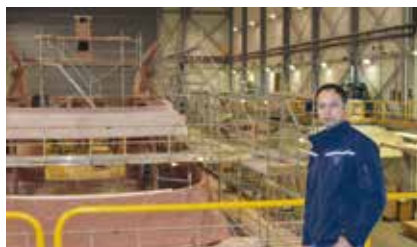
Rino Bouwmeester, Head Utility Department bij Heesen Yachts met op de achtergrond het aluminium, reeds in de grondverf gezette casco van een jacht in aanbouw.
