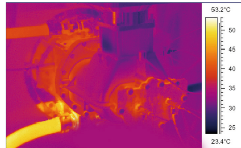
Beperkte toename van de temperatuur van slechts 25 °C in het compressorelement
